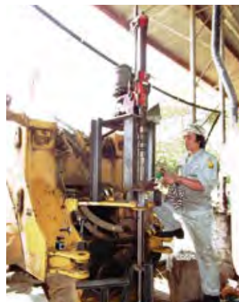
建設機械のフレームの一部を ラインボーリングにて 機械加工中
