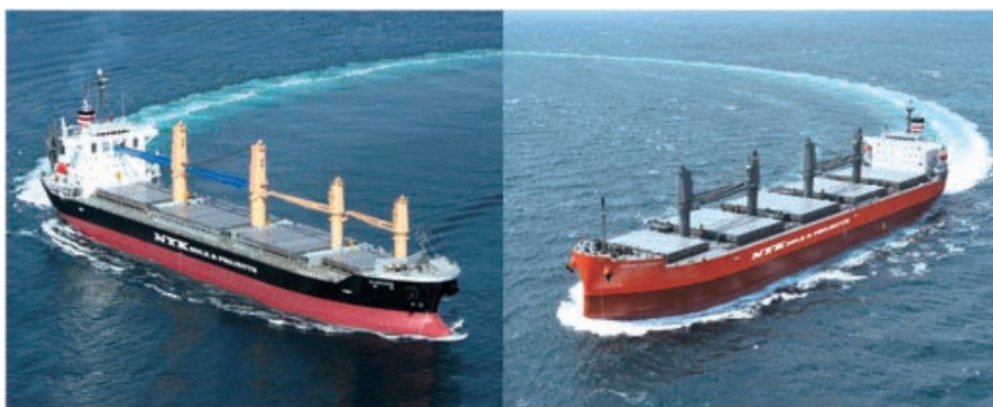
多目的重量物船 8,700~30,000DWT、Max Crane Capacity 450 nt
